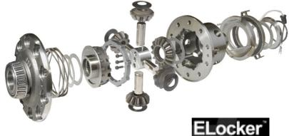
**ELocker****KIT BLOCAGE DE DIFFERENTIEL ELOCKER AVANT
