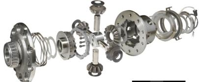
**ELocker****KIT BLOCAGE DE DIFFERENTIEL ELOCKER AVANT
