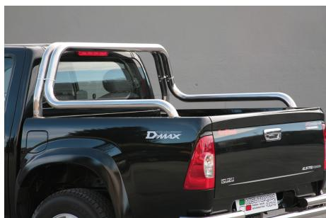
**ROLL BAR INOX DOUBLE TUBE Ø 63MM POUR
