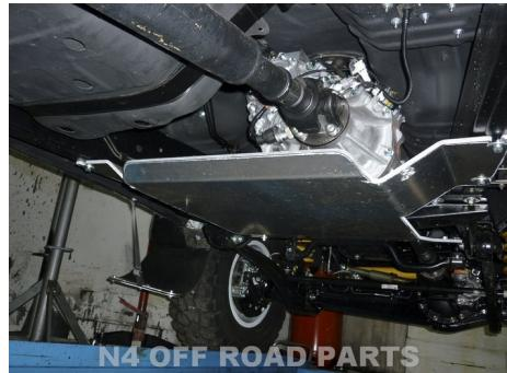
**N4 OFF ROAD PARTS****BLINDAGE BOITE DE VITESSE ET BOITE DE TRANSFERT N4 8MM POUR TOYOTA HZJ 105 ET HDJ 80**
