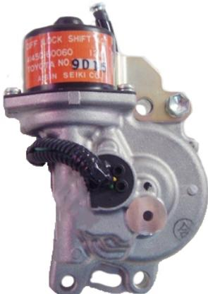
**MOTEUR DE BLOCAGE DE DIFFERENTIEL DE PONT AVANT TOYOTA HDJ80/HZJ105 \*\*ORIGINE TOYOTA\*\***
