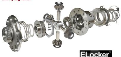
**ELocker®****KIT BLOCAGE DE DIFFERENTIEL ELOCKER AVANT
