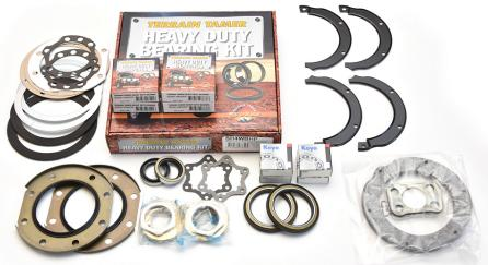
**KIT PIVOT ET ROULEMENTS DE ROUES
