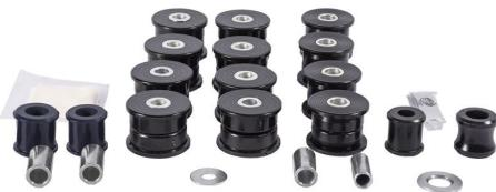
**KIT SILENT-BLOCS Polyuréthane 4 Tirants + 2 Barres Panhard - Pour tirants largeur 35mm**
