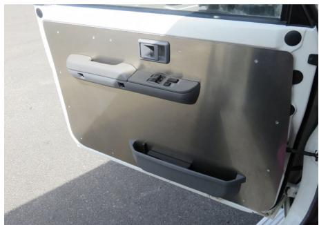
**PANNEAUX DE PORTES AVANT EN ALUMINIUM 2.5 MM POUR TOYOTA LAND CRUISER SÉRIE 7**
