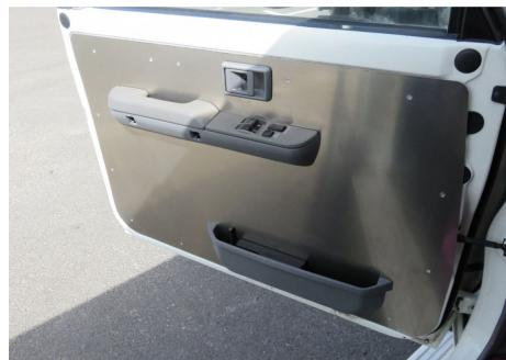
**PANNEAUX DE PORTES AVANT EN ALUMINIUM 2.5 MM POUR TOYOTA LAND CRUISER SERIE 7**
