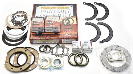
**KIT PIVOT ET ROULEMENTS DE ROUES
