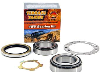
**KIT DE ROULEMENTS DE ROUE AVANT TERRAIN
