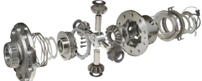
**ELocker®****BLOCAGE DE DIFFERENTIEL ELOCKER AVANT
