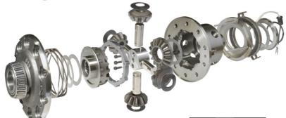
**ELocker®****KIT BLOCAGE DE DIFFERENTIEL ELOCKER AVANT
