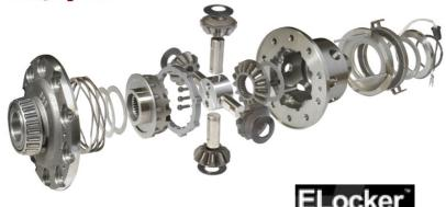
**ELocker®****KIT BLOCAGE DE DIFFERENTIEL ELOCKER AVANT
