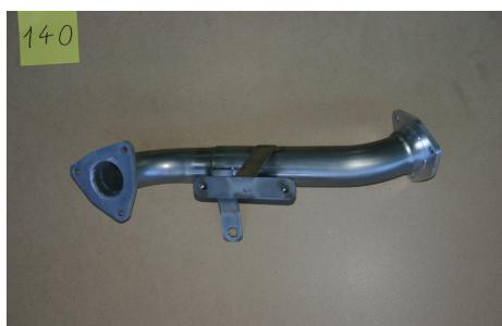
**ECHAPPEMENT INOX : DECATALYSEUR\*\* (n° série >218004 =euro5 ) POUR NISSAN NAVARA D40 DE 2011-2015 EURO 5 2.5L DCI 190HP**
