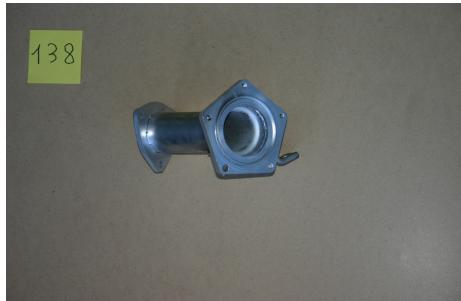
**ECHAPPEMENT INOX : DECATALYSEUR\*\* (n° série <135001=euro3) POUR NISSAN NAVARA D40 DE 2006-2007 EURO 3 ET PATHFINDER R51 DE 2005-2007 EURO 3 2.5 L DCI 174HP**
