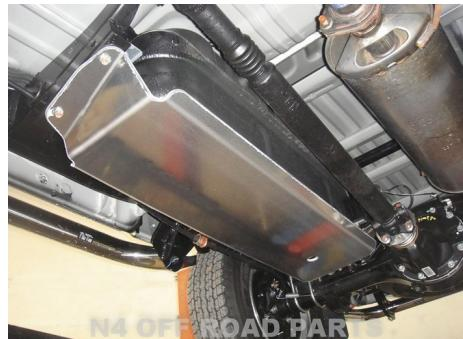
**N4 OFF ROAD PARTS****BLINDAGE DE RESERVOIR N4 6MM POUR FORD RANGER ET MAZDA BT50 AVANT 2011**
