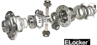
**ELocker****BLOCAGE DE DIFFERENTIEL ELOCKER AVANT
