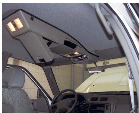
**CONSOLE DE TOIT LONGITUDINALE ARB POUR MAZDA BT50 ET FORD RANGER AVANT 2012**
