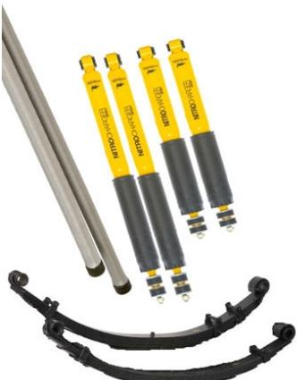
**KIT DE SUSPENSION OME NITROCHARGER PLUS REHAUSSE +40/50MM TARAGE +400KG POUR MAZDA BT-50 1 TONNE 12/2006-2011 TOUS MODELES**
