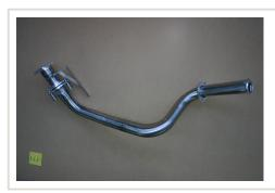
**ECHAPPEMENT INOX: DECATALYSEUR\*\* POUR** LAND ROVER DEFENDER 90/110/130 DE 2007-2012 **TD4 2.4L**
