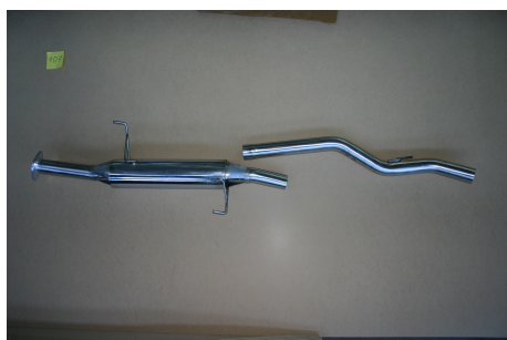
ECHAPPEMENT INOX : INTERMEDIAIRE AVEC SILENCIEUX ET TUBE ARRIERE (non dissociable) POUR ISUZU D-MAX DE 2005-2012 3.0L TD
