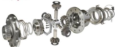
**ELocker****BLOCAGE DE DIFFERENTIEL ELOCKER AVANT
