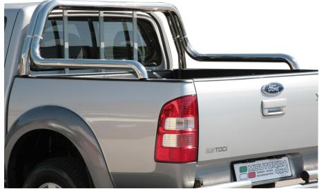
**ROLL BAR INOX DOUBLE TUBE Ø 63MM POUR FORD RANGER DE 2007 A 2011**
