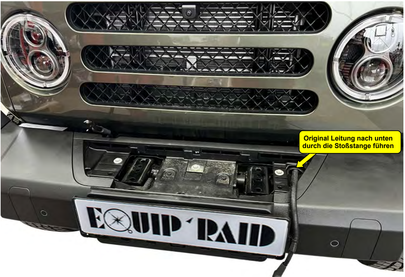
12 Jetzt kann die Seilwinde entfernt werden / Now the winch can be removed
