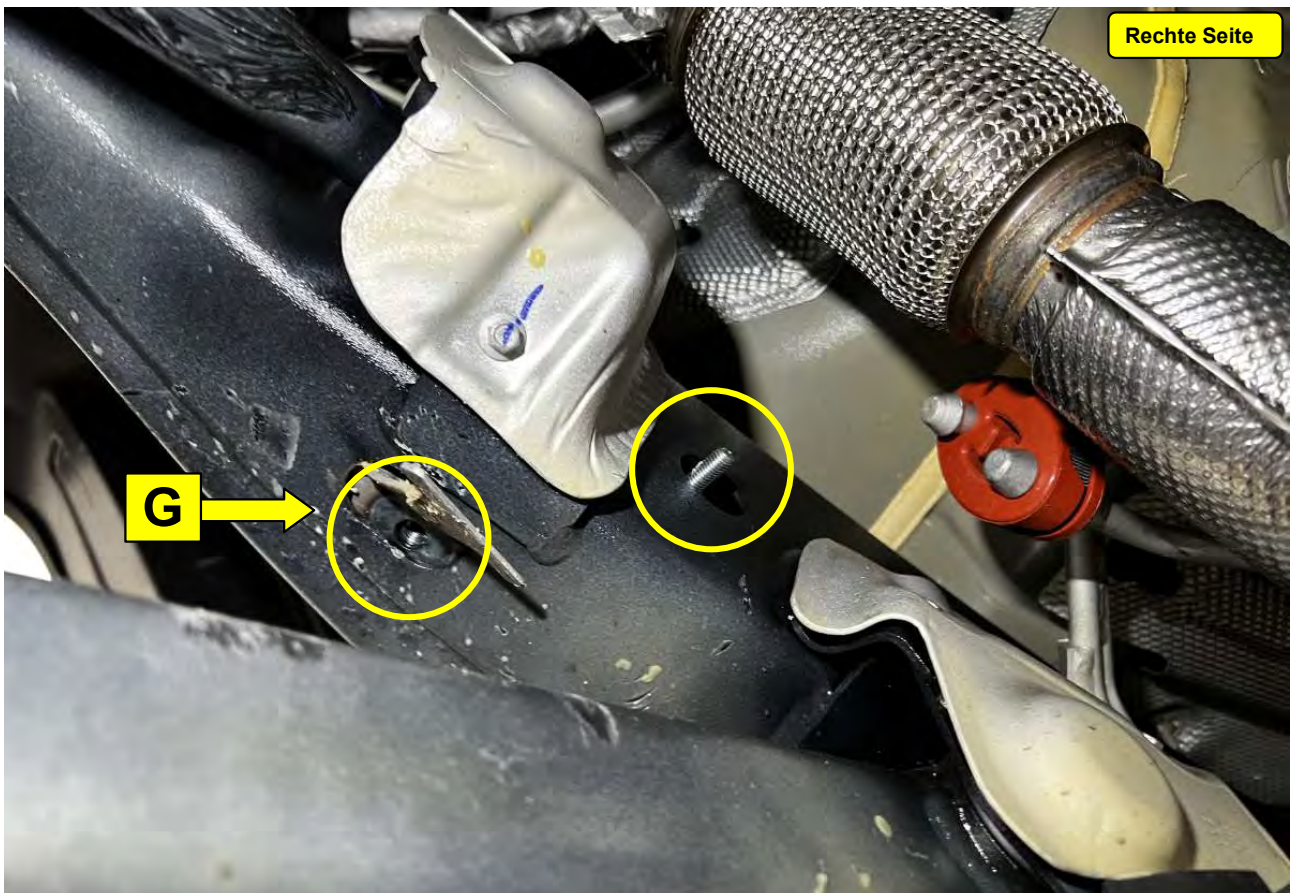
5 Gegenhalter Rechts (G) eingelegt / Right counterholder (G) inserted
