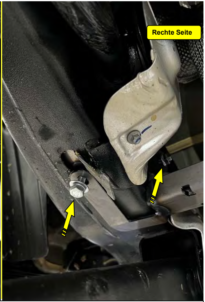
12 Jetzt die äusseren Befestigungen festziehen / Tighten the outer fasteners now Tighten the outer fasteners now
