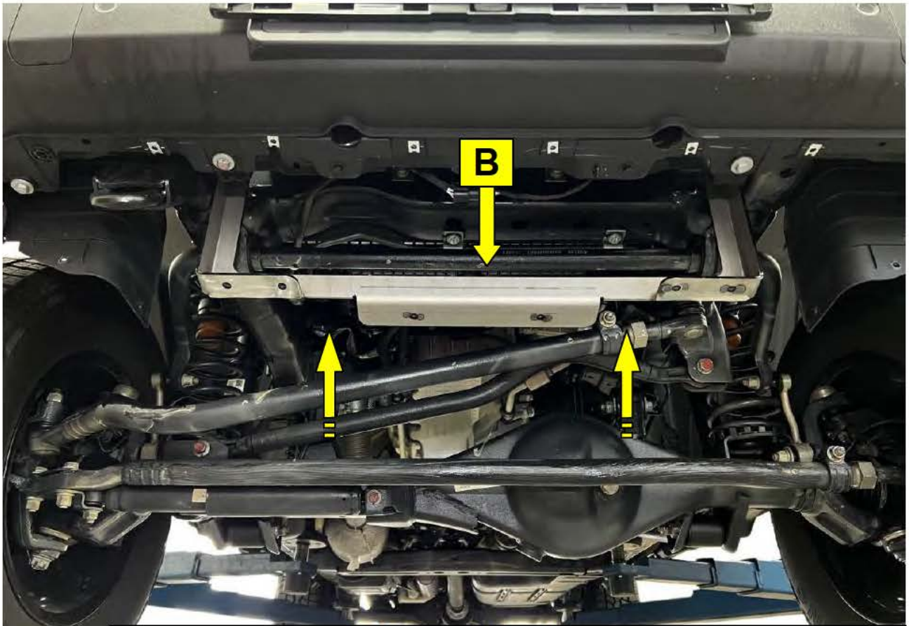
3 Halterung (B) anbringen / Attach the bracket (B)
