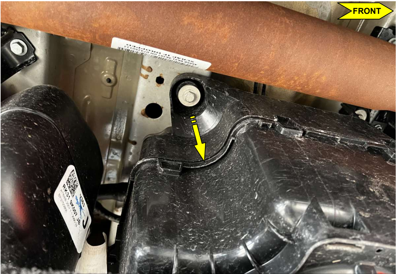
3 Original Schraube entfernen / Remove the original bolt
