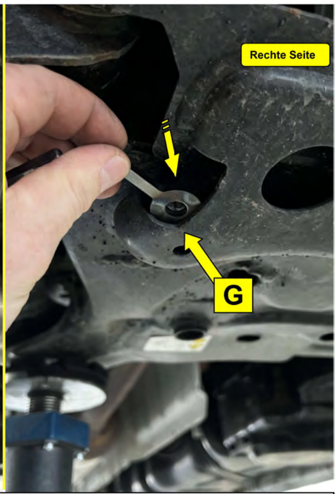
Die Gegenhalter Hinten (G) in Achsträger einschieben / Slide the rear counterholder (G) into the axle carrier
