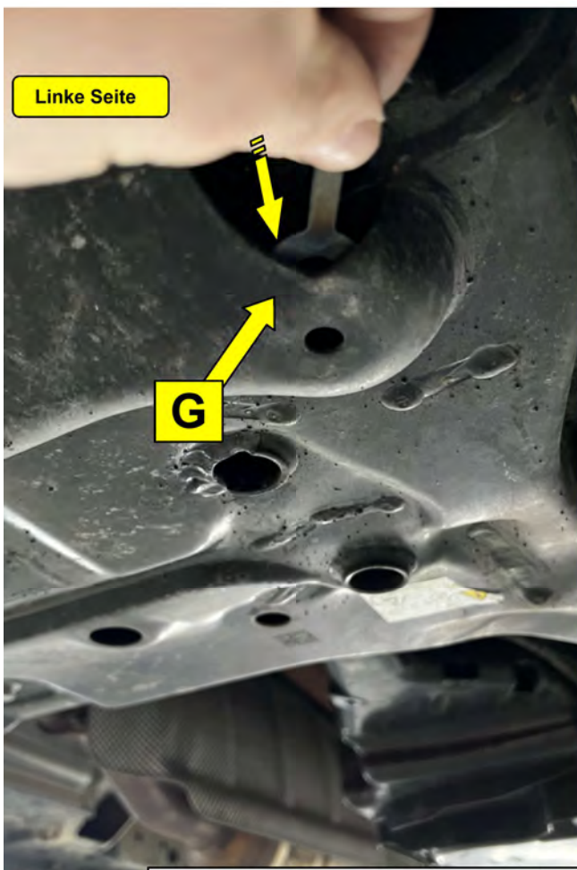
Die Gegenhalter Hinten (G) in Achsträger einschieben / Slide the rear counterholder (G) into the axle carrier
