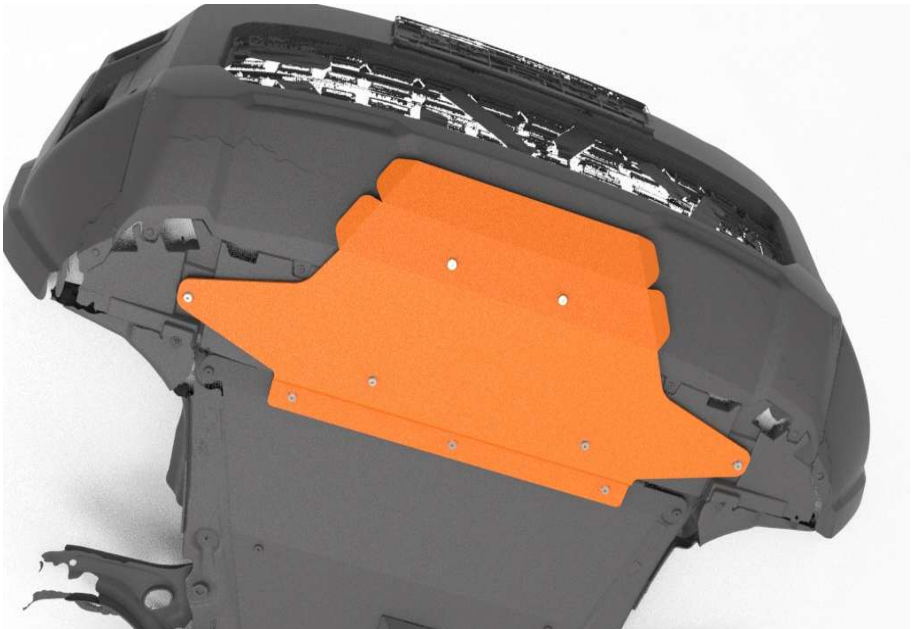
11 Alle Schrauben, von vorne beginnend, festziehen! Tighten all screws starting from the front!
