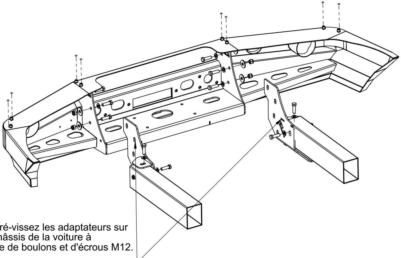
1. Pré-vissez les adaptateurs sur le châssis de la voiture à l'aide de boulons et d'écrous M12.
