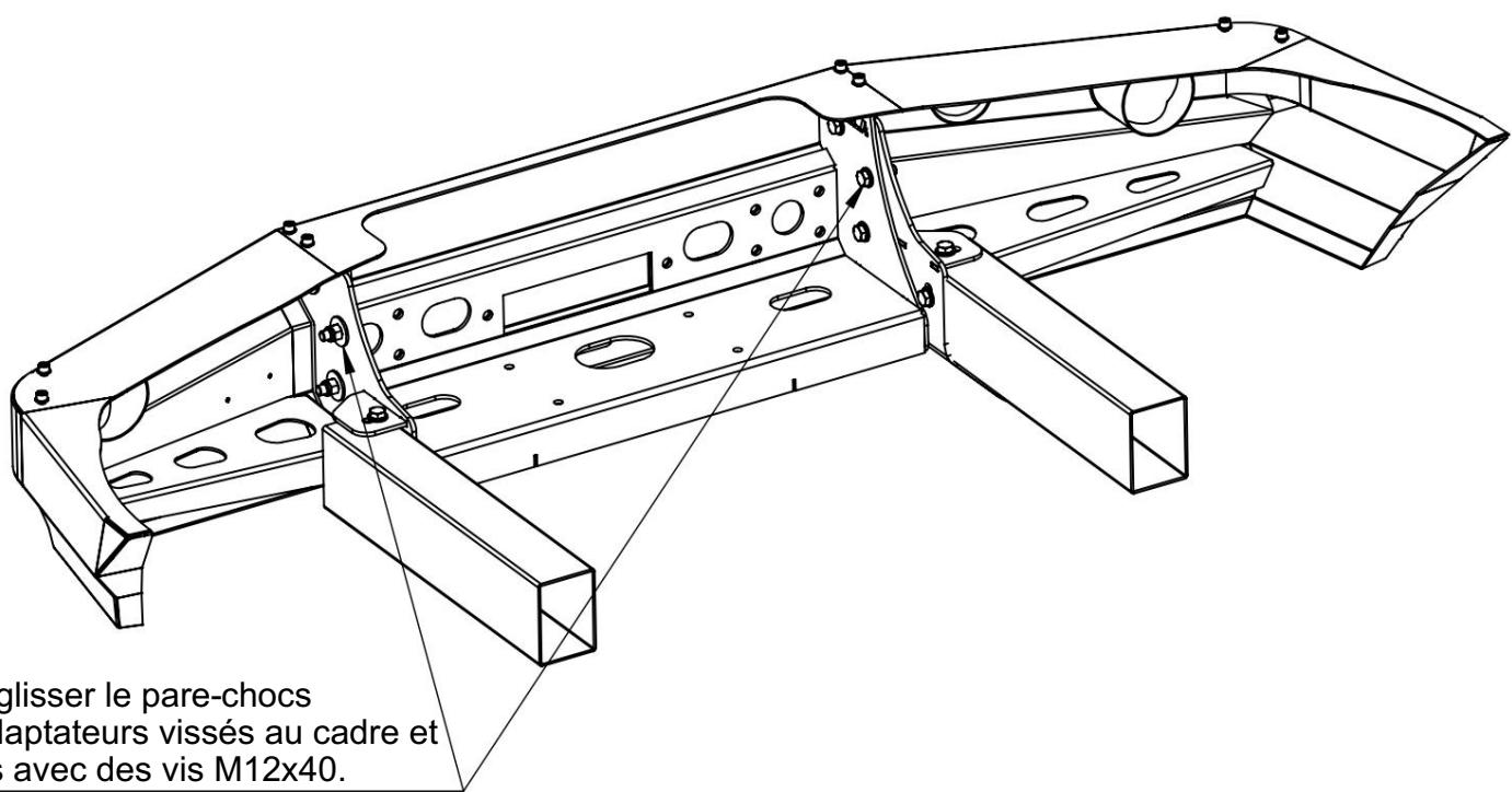
2. Faites glisser le pare-chocs sur les adaptateurs vissés au cadre et serrez-les avec des vis M12x40.
