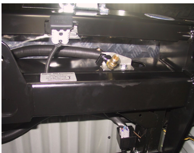
Photo 8 : Montage à l'aide d'un taraud avec barre arrière Kaymar
