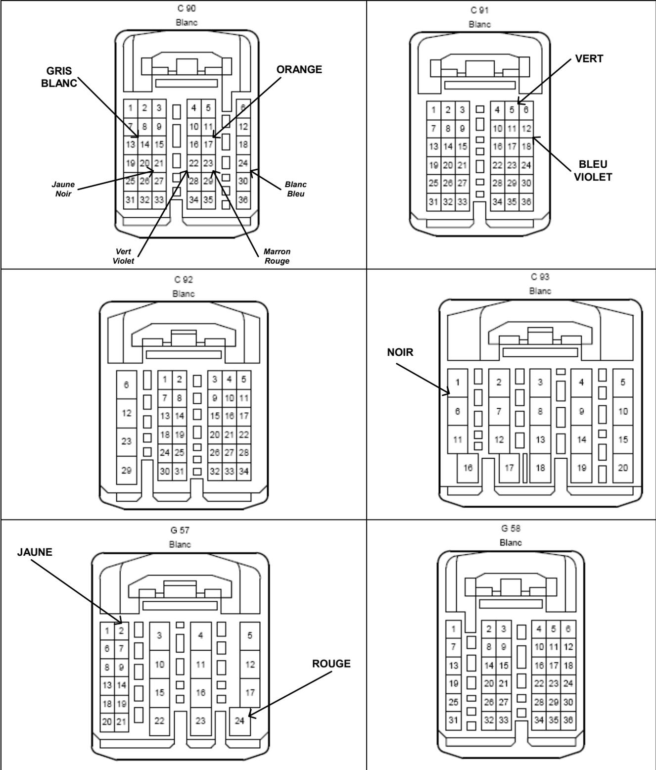
Les connections suivantes seront faites en faisant des épissures de 1cm environ sur les fils du faisceau d'origine (connections en //) .
