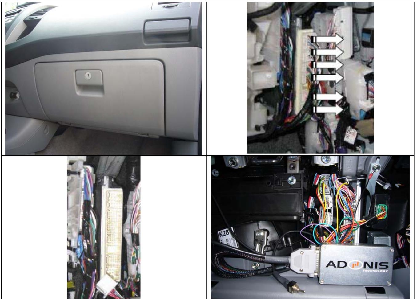
**Connexion du faisceau Adonis sur le faisceau d'origine!**
