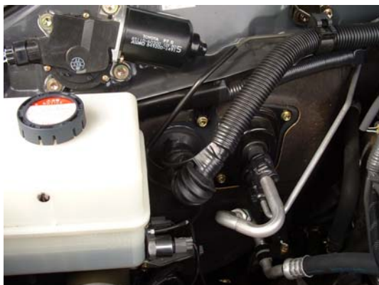
Passage des 2 câbles noirs
