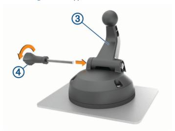
6 Insérez la vis de serrage 4 dans le support, puis serrez pour la fixer au bras du support à rotule.
