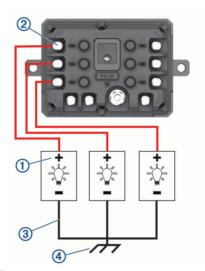
2 Branchez le fil négatif ou de terre ③ à une borne de terre non peinte ④ sur le châssis du véhicule, à un bloc de distribution de terre ou directement à la borne négative de la batterie.
