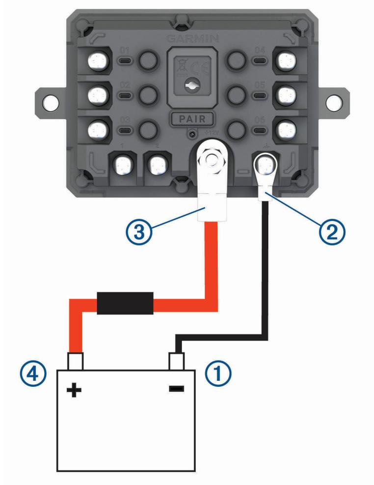
2 Connectez l'extrémité à petite cosse du fil de masse à la borne **GND** ② de l'appareil.
