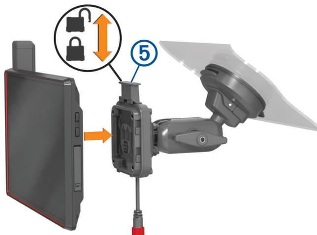
9 Appuyez sur le verrou ⑤ pour fixer l'appareil au support.
