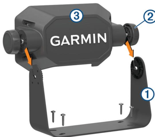
2 En vous servant d'un foret de taille adaptée pour le matériel de montage, percez les trous d'implantation. Ne percez pas à travers le support,
