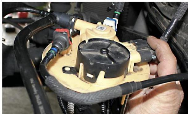
Photo 3 : Débrancher le câblage
