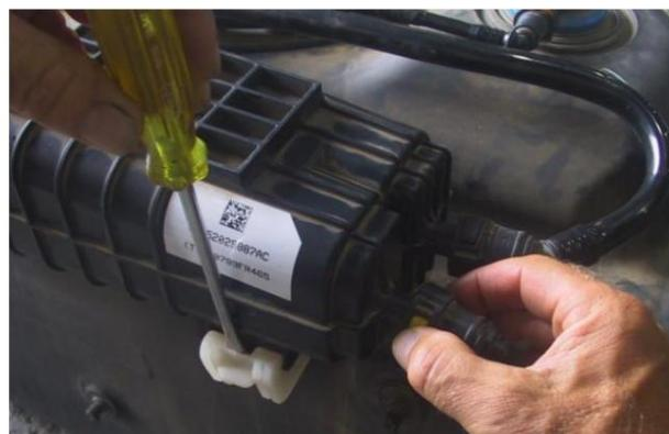
Photo 6 : Déclipser le bidon de carbone
