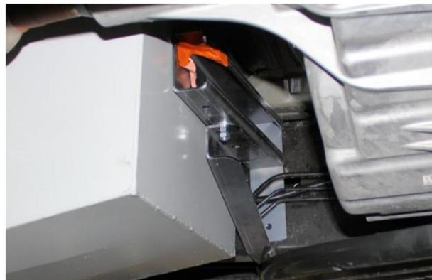
Photo 10 : Mise en place des supports de stabilisateur
