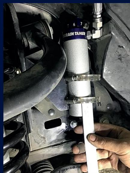
Étape 8 - Ajustez le réservoir à distance avec une mesure de 30 mm de l'extrémité inférieure de la cartouche à la position de serrage pour le dégagement de la barre anti-roulis.
