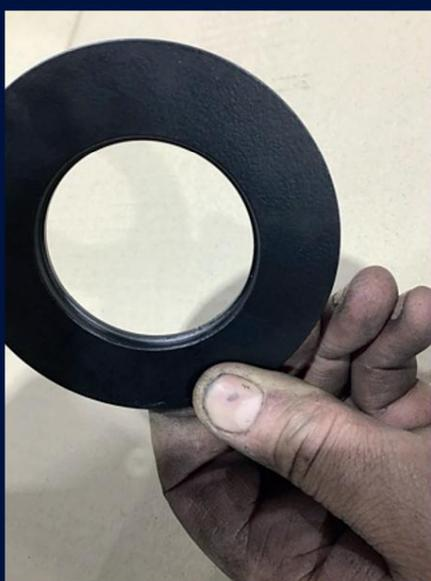
Étape 1 - Lors du montage des amortisseurs, placez la fine bague noire avec la rainure vers le bas
