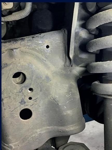
Étape 4 - Côté gauche. Localisez le trou de montage de la plaque dans le châssis (normalement taraudé à 8 x 1,25 mm).
