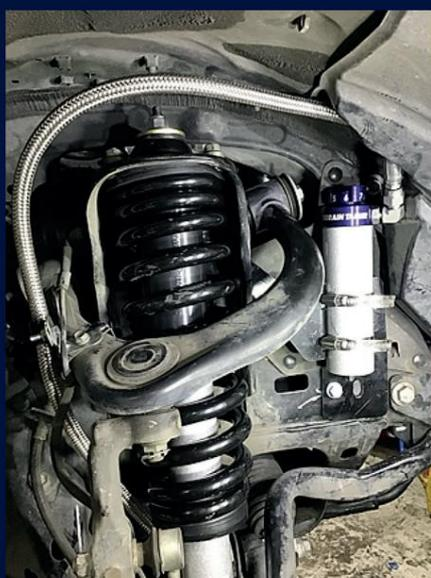
Étape 7 - Fixez le tuyau flexible au bras de commande supérieur avec le support à angle droit fourni à l'aide du boulon existant.
