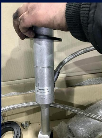
Étape 2 - Assurez-vous que le circlip de retenue est entièrement recouvert par le disque noir
