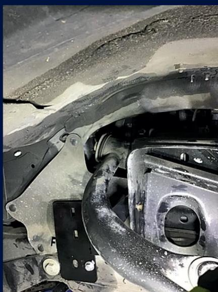
Étape 6 - Montez le support tel qu'illustré avant d'installer l'assemblage du serpentin avec l'écrou à l'extérieur de la tour du serpentin à l'aide des rondelles fournies.
