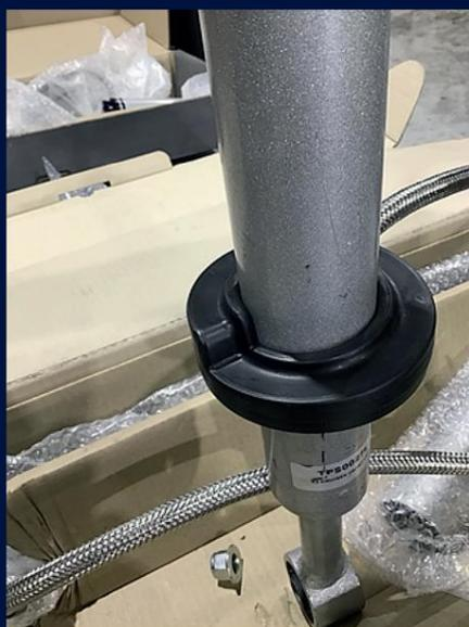
Étape 3 - La position idéale du siège à ressort est celle indiquée avec le tuyau flexible à l'arrière (sur cette photo).
