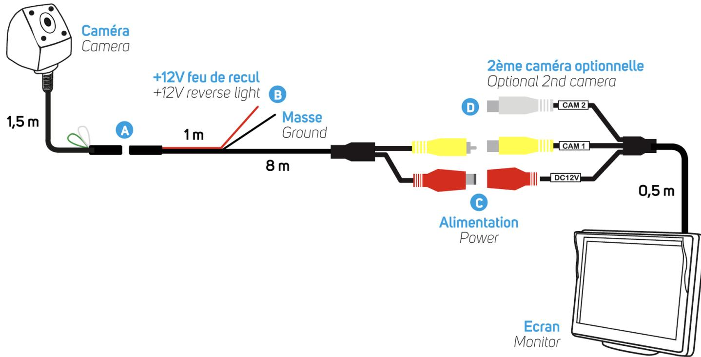
Schéma d'installation pour deux caméras (seconde caméra optionnelle - non fournie) :
