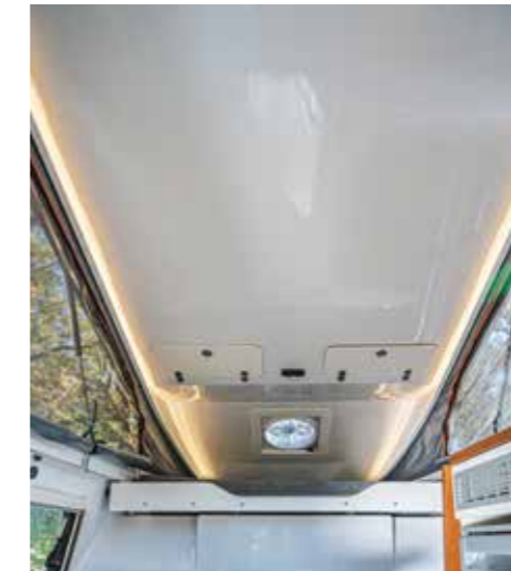
Toit relevable Stork Camper (isolation en fibre de verre de 20 mm entre les coques)
