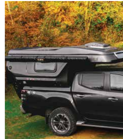
Cellule aérodynamique monobloc de Stork Camper (isolation en fibre de verre de 20 mm entre les coques)
