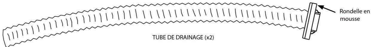
**Remarque** : si les trous de drainage d'origine sont placés sur la paroi avant de la benne assurez-vous bien que le tube est en position descendante afin que l'eau puisse s'évacuer.
