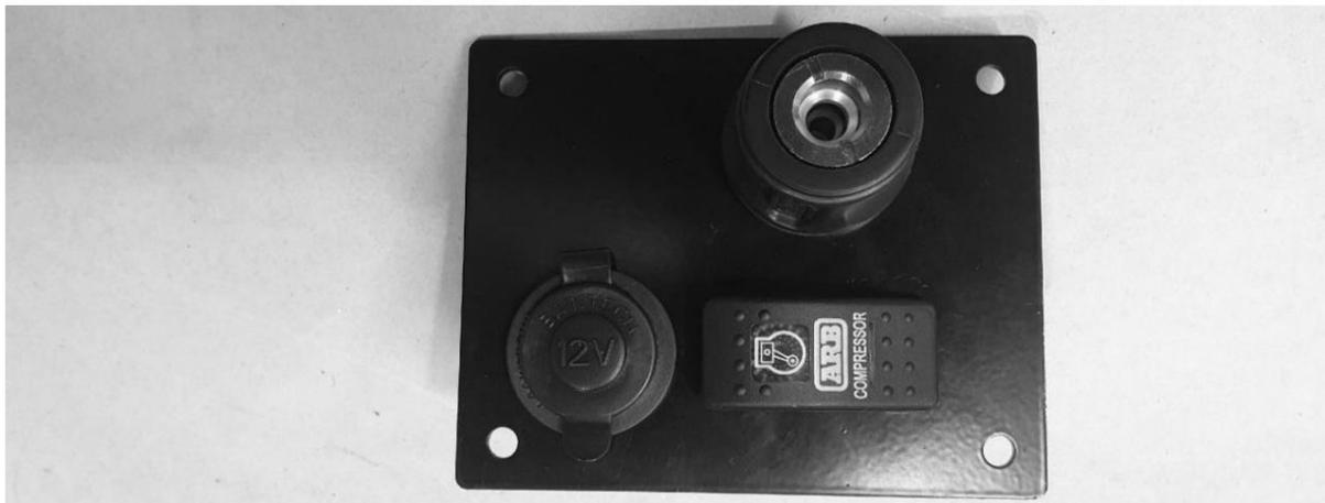
Insérez la plaque d'interrupteur assemblée à l'intérieur de la poche comme illustré. Serrez le raccord à l'aide d'une clé de 14 mm.
