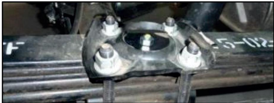
**↳ Étape 3 : Pré-assembler le ressort pneumatique et le support supérieur**
