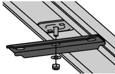
8. Installez la plaque de pontage sur le goujon à l'aide d'un écrou et d'une rondelle M8
