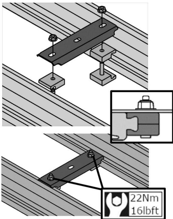
10. Disposez les blocs de montage en alliage (réf. ARB 1780200 ou 1780610) pour les serrer sur la queue d'aronde BASE Rack, comme illustré
