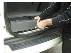
Retirez le cadre métallique en desserrant les deux boulons de 10 mm.
