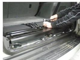
Retirez les plaques latérales en desserrant les deux boulons à l'aide d'une douille de 10 mm, d'une rallonge et d'un cliquet.
