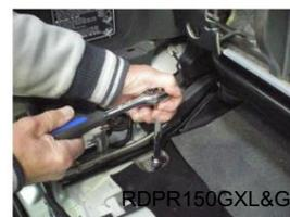
Éloigner le faisceau de câblage de la fixation, débrancher le faisceau de câblage (modèles à siège Dickie à commande électrique)
