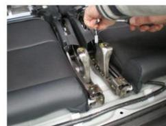
Mettez les deux sièges de la troisième rangée en position verticale, dévissez deux boulons de chaque côté à l'aide d'une douille de 14 mm, d'une barre d'extension et d'un cliquet.
