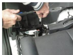
Retirez les sièges de la troisième rangée en desserrant les deux boulons centraux à l'aide d'une douille de 14 mm, d'une barre d'extension et d'un cliquet.
