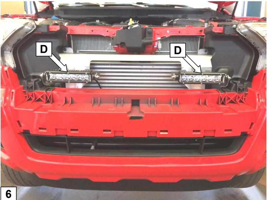
Scheinwerfer, nach Anleitung, anschließen und ausrichten!
