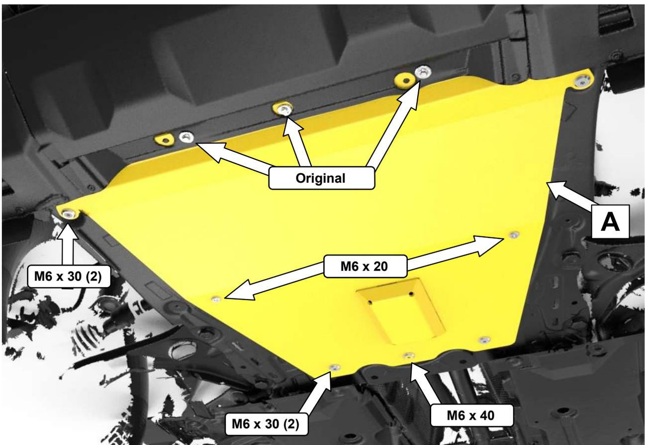
**8** Schutzblech verschrauben! / ScREW the skidplate!
