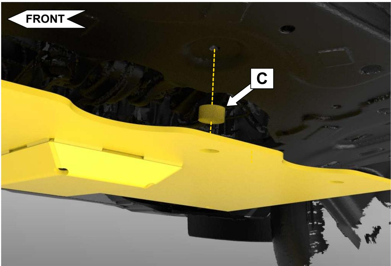
**7** Distanzscheibe „C“ unterlegen! / Place spacer washer „C“ underneath!
