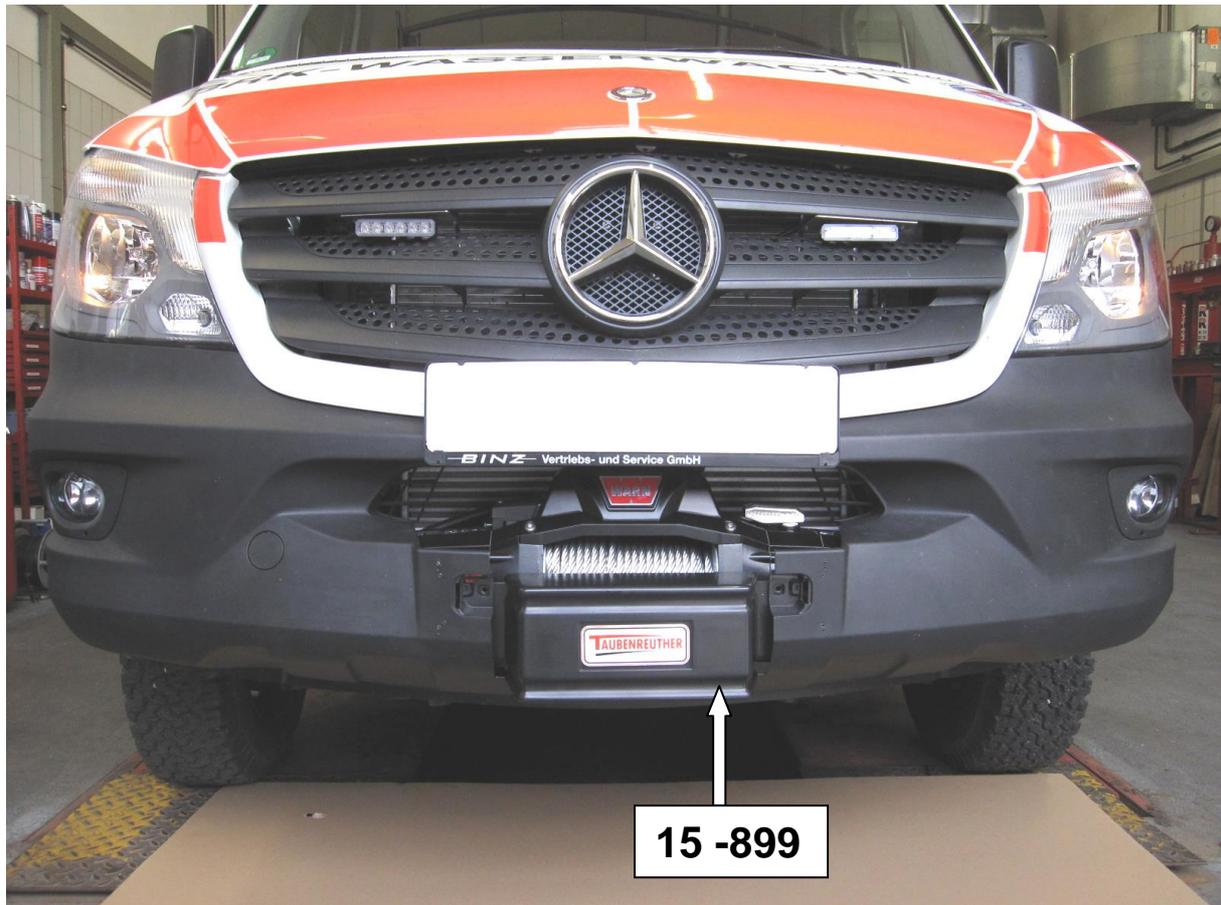
Hier sehen sie den fertig montierten Seilwindenanbausatz.
