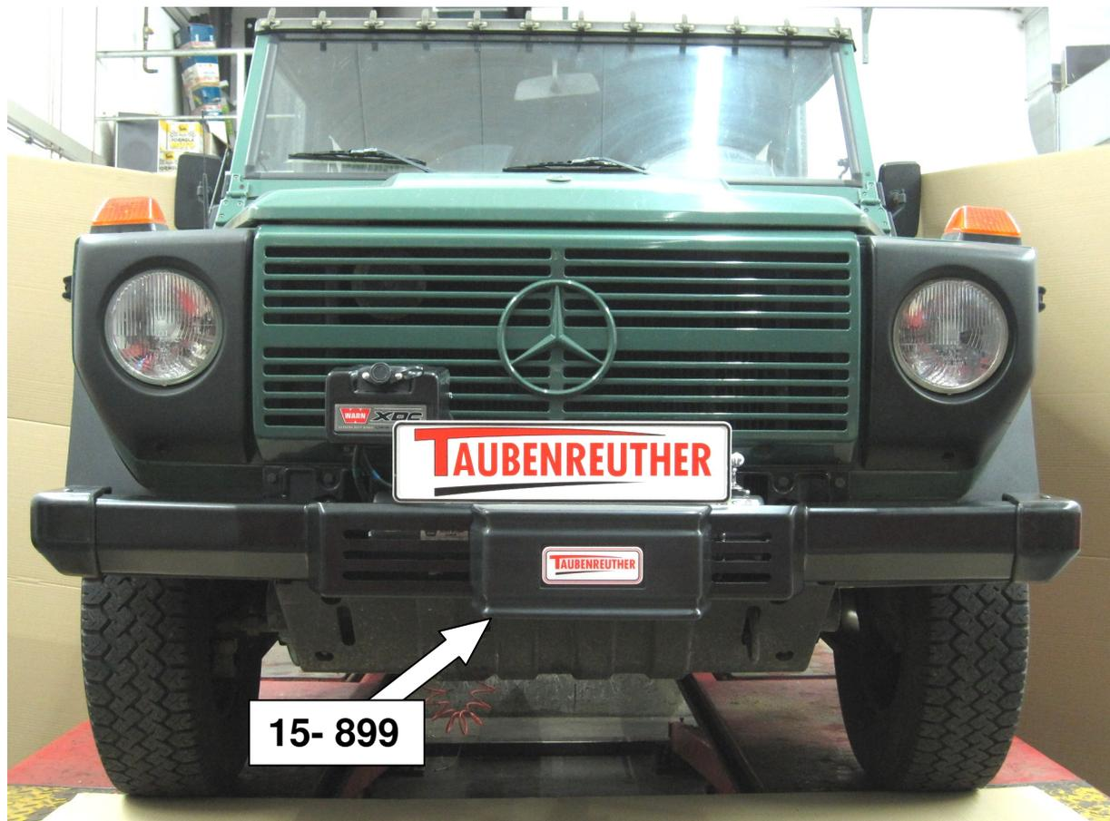
**Hier sehen sie den fertig montierten Seilwindenanbausatz.**
