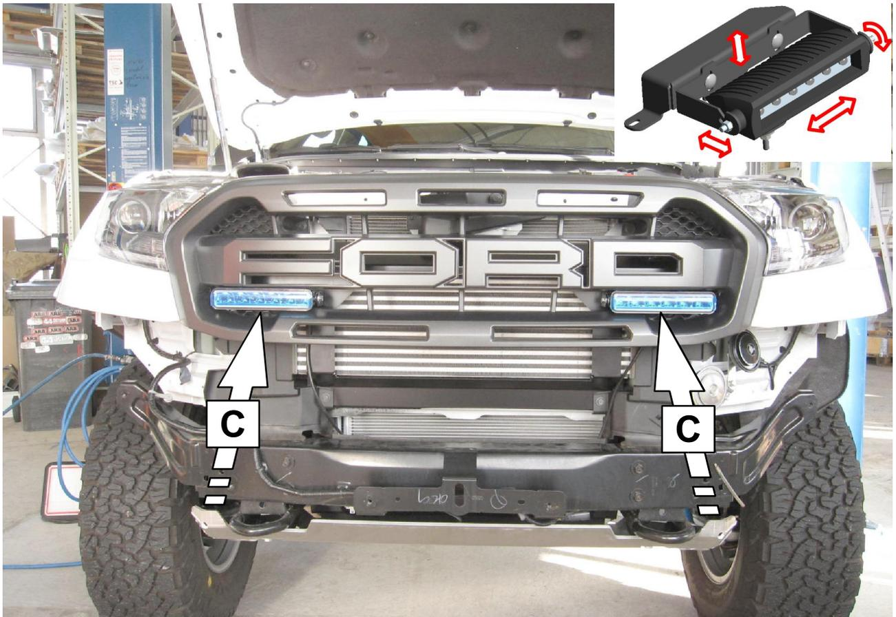
**11** **Scheinwerfer einbauen, nach Anleitung anschließen, ausrichten und festziehen!**
