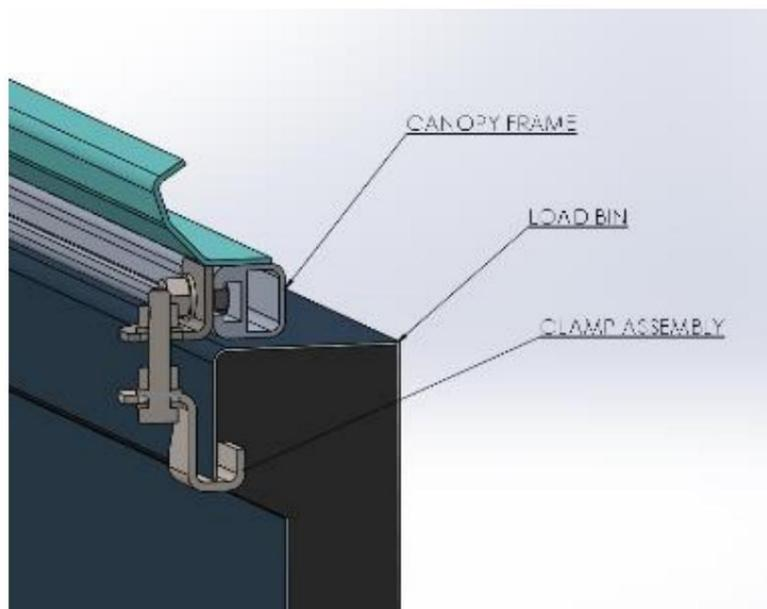
Figure 15 : Vue en coupe de la méthode de serrage
