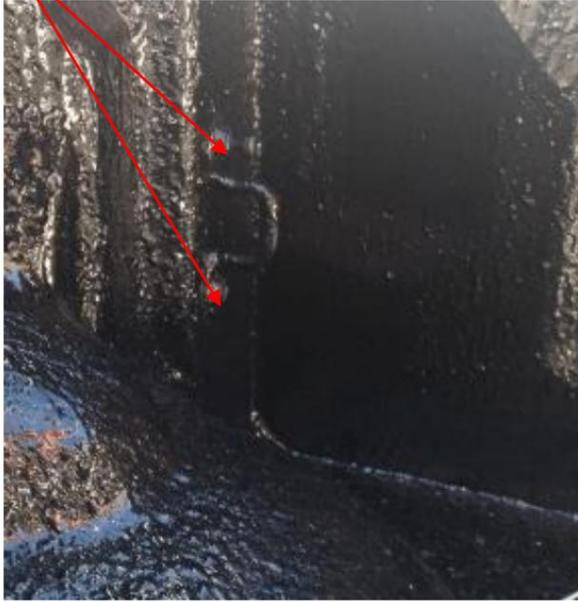
Figure 3 : Points de crochet standard
