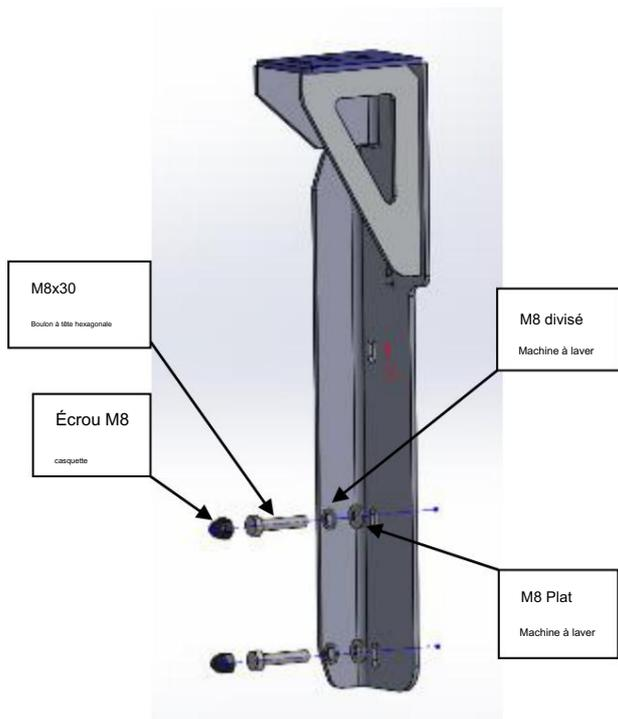
Figure 9 : Ensemble de montage du support arrière
