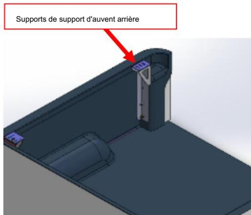
Figure 7 : Position du support de support de l'auvent arrière
