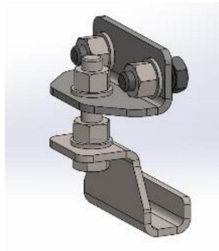
Figure 14 : Assemblage du support de montage central
