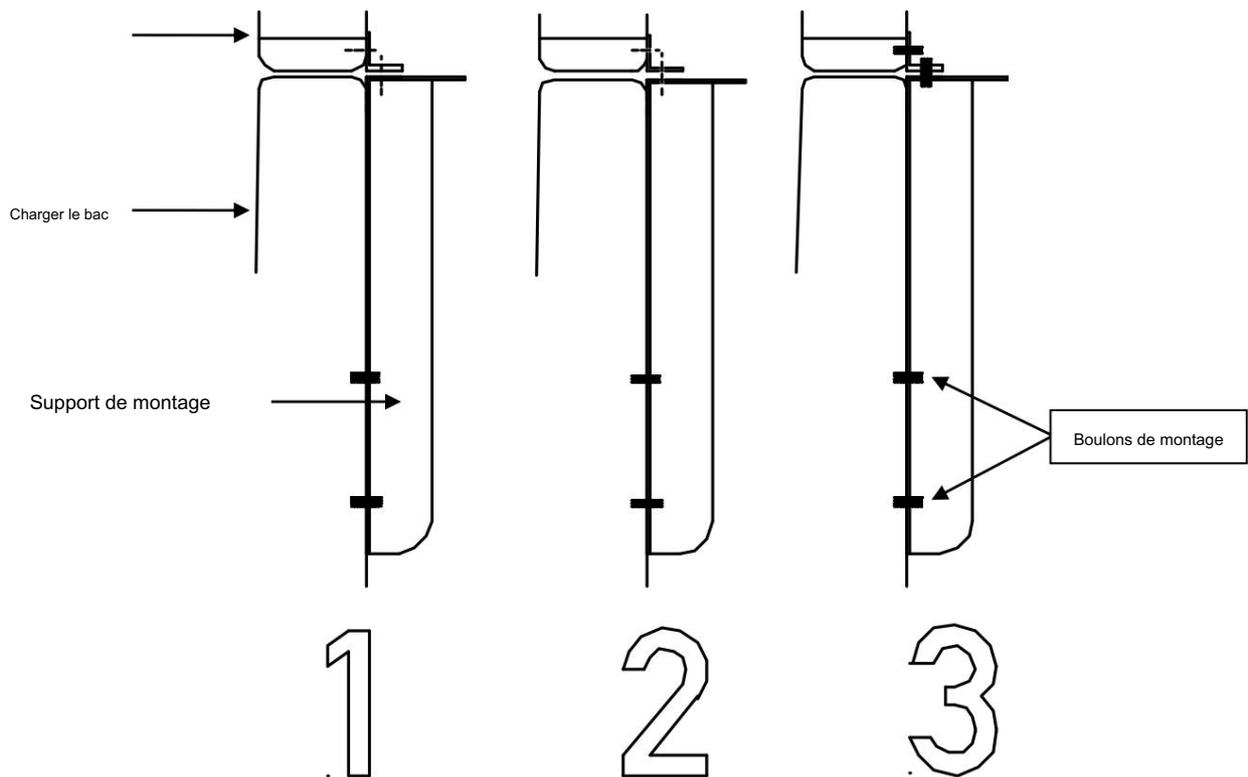
Figure 22 : Assemblage global du raccord
