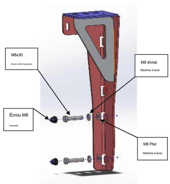
Figure 10 : Assemblage de montage du support avant
