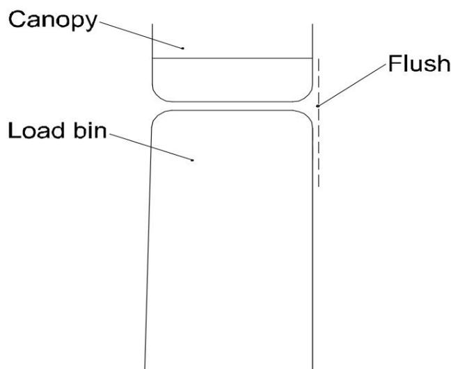
Figure 16 : Alignement de l'auvent et du bac de chargement
