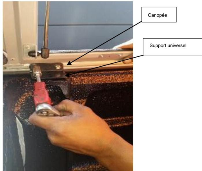
Figure 21 : Serrage du support universel sur l'auvent
