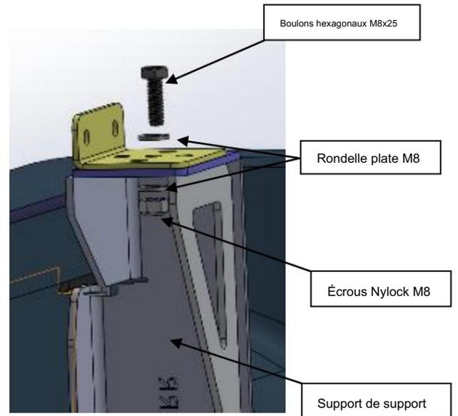
Figure 18 : Support arrière universel
