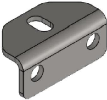
Figure 11 : Support de montage de l'auvent
