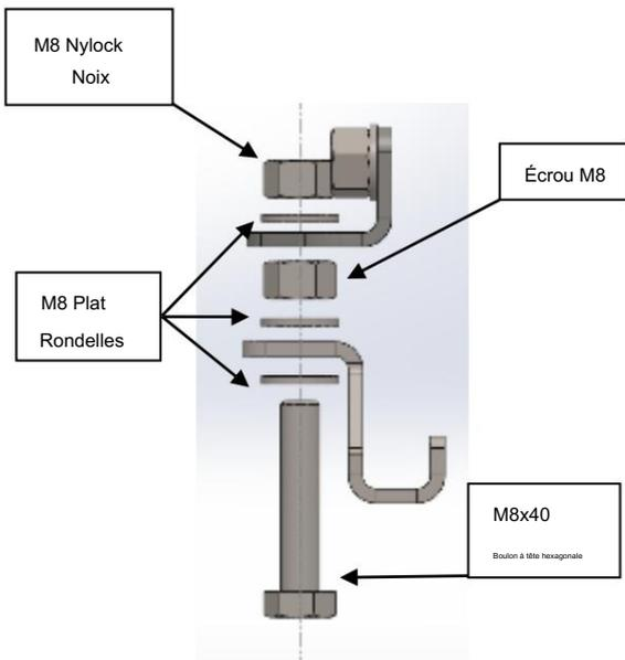
Figure 13 : Assemblage de montage du support central
