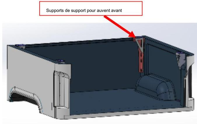
Figure 8 : Position du support de support de l'auvent avant
