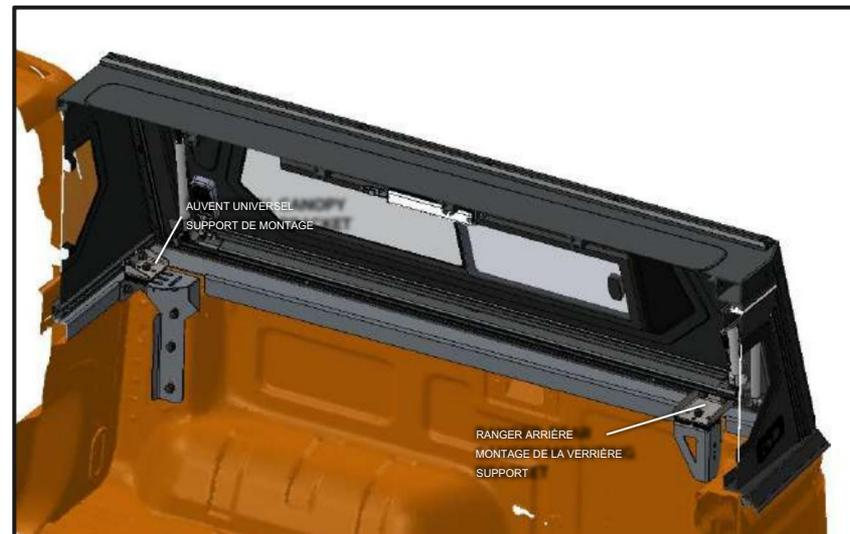
Fig 21. Position des supports de montage de l'auvent
