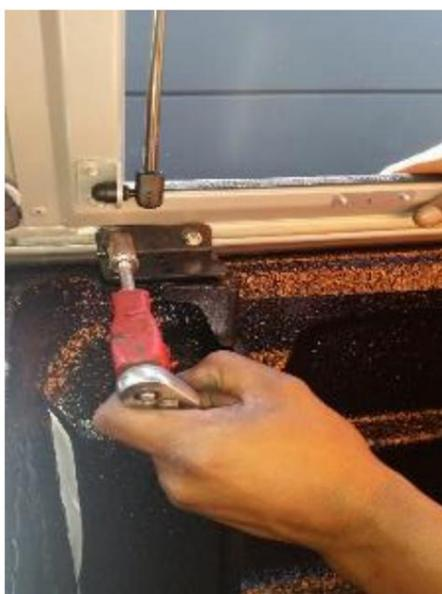
Figure 21 : Serrage du support universel à l'auvent
