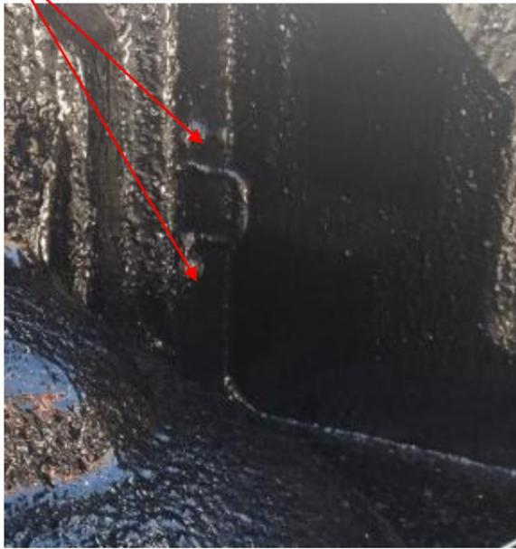
Figure 3 : Points de crochet standard
