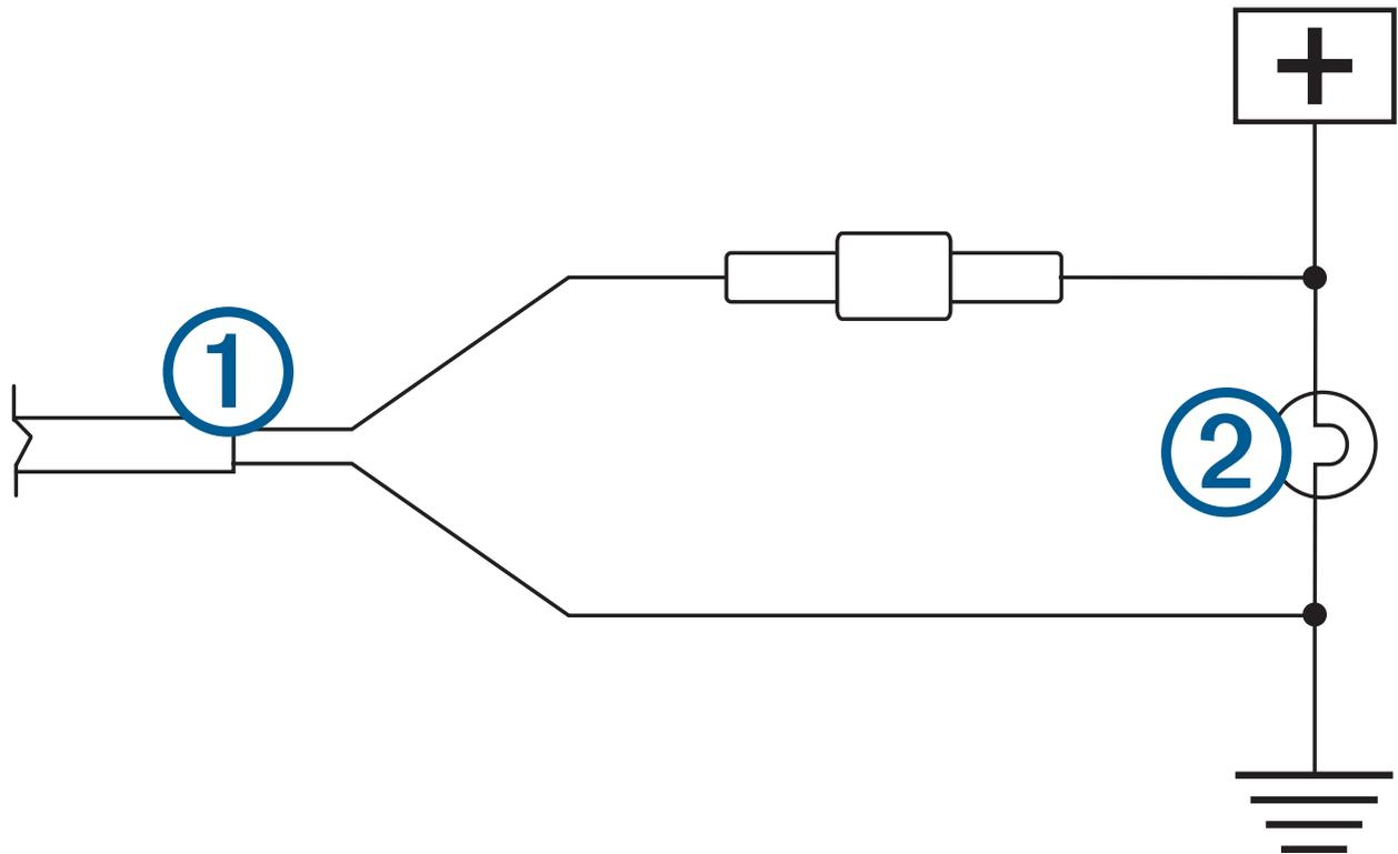
**REMARQUE :** si vous reliez l'émetteur à une source d'alimentation permanente de 12 à 24 V c.c. (aux feux de circulation, par exemple) et non pas aux feux de marche arrière, vous devrez allumer et éteindre l'émetteur manuellement. Si vous le laissez allumé en permanence, l'émetteur risque de décharger la batterie de votre véhicule.
