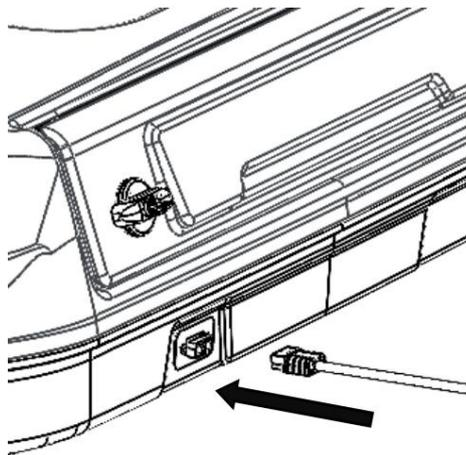
4.1) Se référant au manuel du propriétaire (fournisseur dans le kit de montage), connectez l'alimentation 12 V via la prise Anderson à l'arrière de la tente sur le toit.
